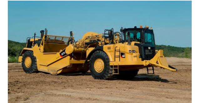
Figure 115 - Décapeurs (source: construction cayola)
